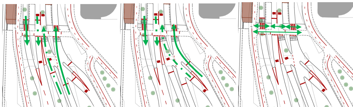
Figur 14 Principiell fasväxling i trafiksignalanläggning 4102 ring 1
